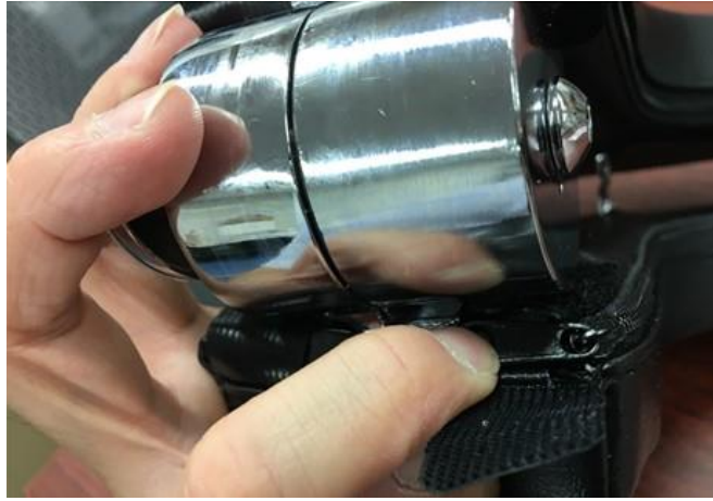
スライダーを手で押さえながらベルクロを留めます。
