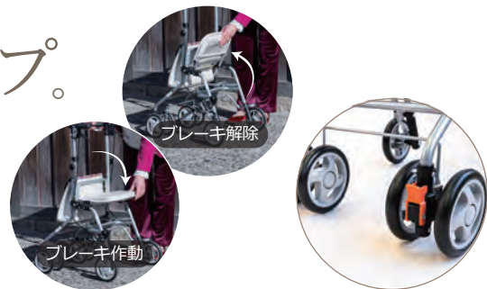
座面を下げると自動的にブレーキがかかり、上げると解除されます。
